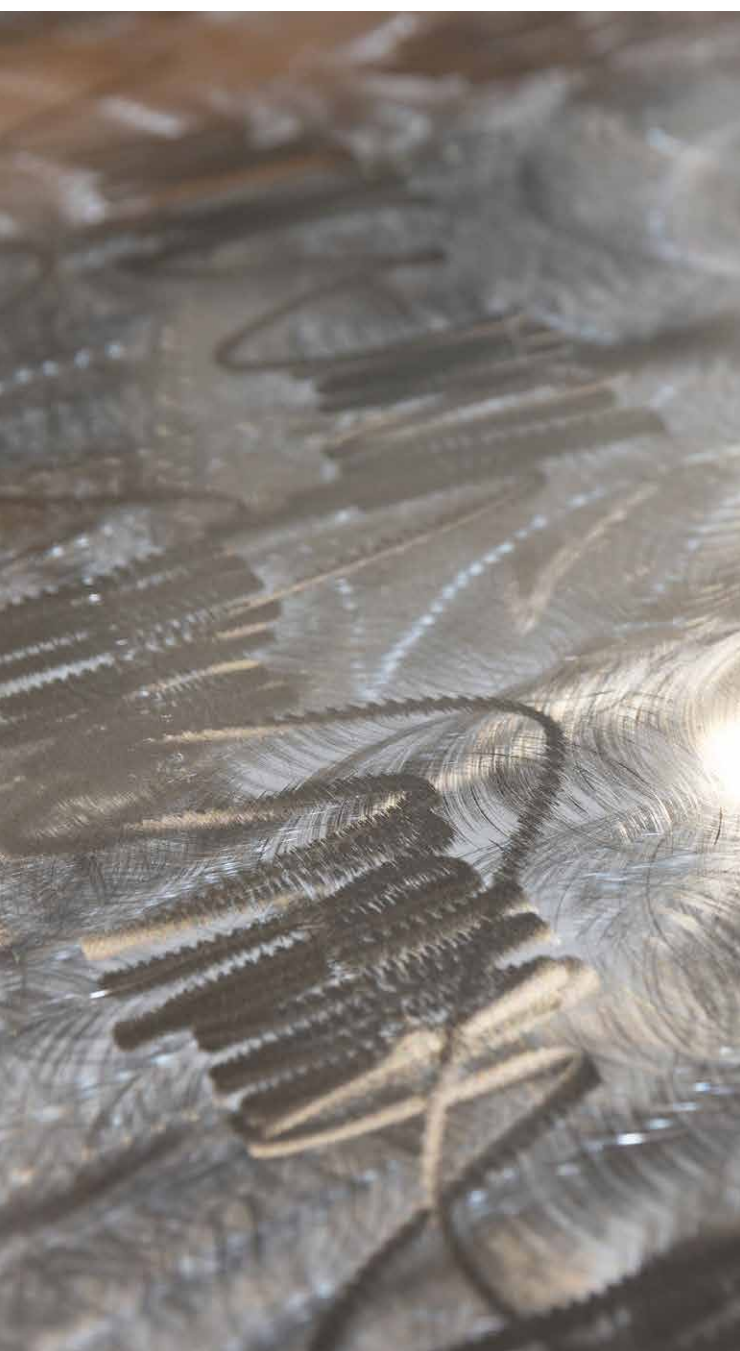
Blech vorbereitet für die Beschichtung in den Werkstätten der ROMAG AG
