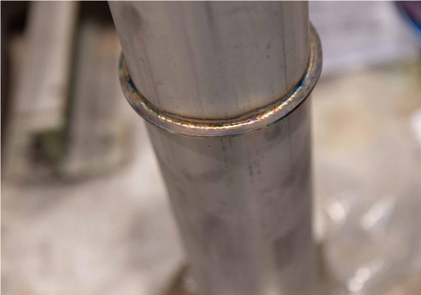
Soudure d'angle dans un dispositif rotatif pour la construction de tuyauteries
